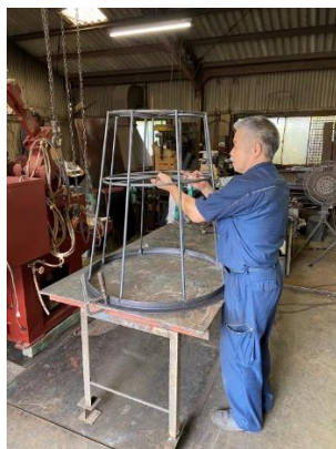
【図20】 地元鉄工所「カジャス」が焼成用の鉄筋フレーム制作協力
