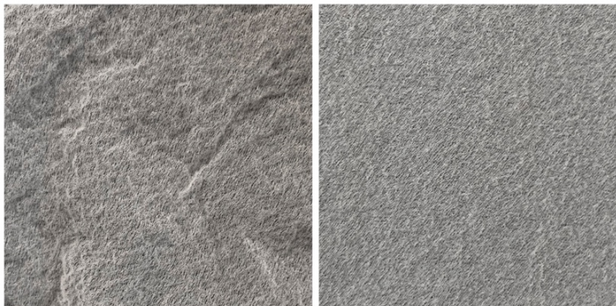
図 21 手による整理加工(左)と機械による整理加工(右)の比較 筆者撮影
